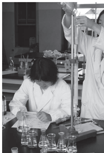
図3 カラムクロマトグラフでステロール類を分離する生徒 これをGC-MS分析する
