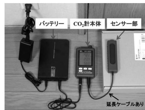
写真2 学生が使用するCO<sub>2</sub>計
