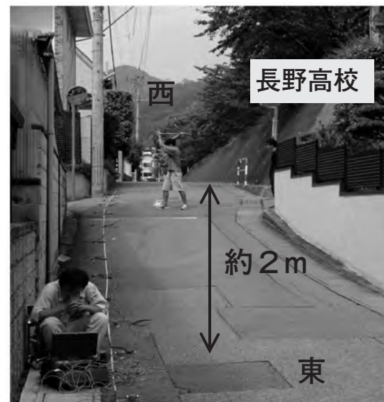
長野高校南側の市道で大型の木樁で人工の地震をおこし、その表面波を受信機で測定して地震のS波速度を推定しているところ。S波速度は比較的浅い地質構造を知る上で有効な手段で、この調査から長野高校付近は複数の断層による変位地形であることが推察された 写真の矢印は長野高校東端にみられる2mの段差を示している
